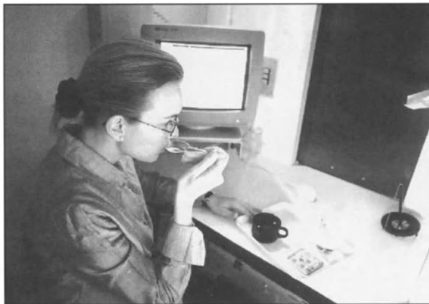
Abb. 2 : Geschulter Prüfer bei der beschreibenden Prüfung. Die Farbe des Produkts wird durch Rotlicht maskiert [Photo: Nestec].
