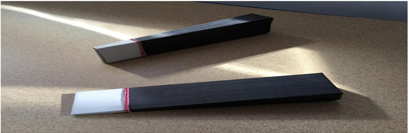
Die Zeigestäbe (pro Team einer mit teamabhängiger Kennung) sind prototypisch selbst entwickelte Lesegeräte für Nahfeldsensoren mit WiFi-Verbindung zum zentralen Rechner. Sie können verwendet werden, um im Raum platzierte Nahfeldsensoren als gefunden zu markieren. So kann beispielsweise hinter eine Abbildung auf einem Plakat ein solcher Sensor angeklebt werden und kostengünstig eine Interaktion mit den gedruckten Informationen auf einer Papier- oder Stoffbahn realisiert werden.
